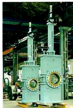
Típica válvula wedge gate valve de entrada à Torre Fracionadora
