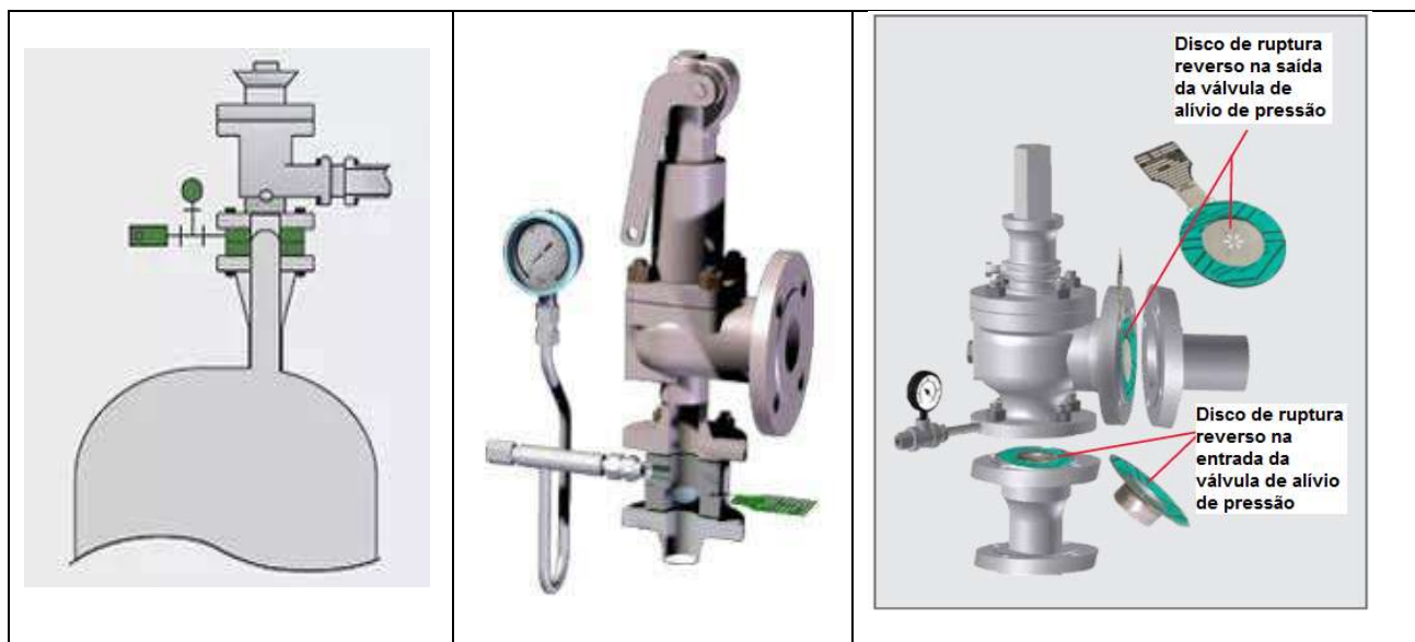
Monitoramento do espaço entre a válvula de alívio de pressão e o disco de ruptura à montante
