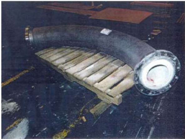
Material cerâmico: Corguard® (Fundido: Alumina+Zircônio+Silica)
