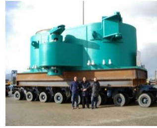
Típica válvula two port diverter valve
