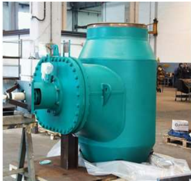
Típica válvula de controle tipo single disc slide valve
